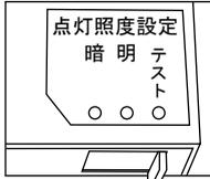
■周囲が明るい時でも、人を検知するたびに、約5秒間全光点灯します。器具の周囲を歩き、検知エリアの確認、調整を行ってください。
