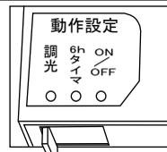
\*壁スイッチONにした直後は電球が点灯⇒消灯になりますが故障ではありません。約1分後に設定したモードで動作します。
