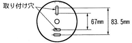
●グローブの取り付けが回転方式ですので、壁等に接近して取り付ける場合は、グローブの回転範囲（直径約185mmの円）をご考慮のうえ取り付けてください。
