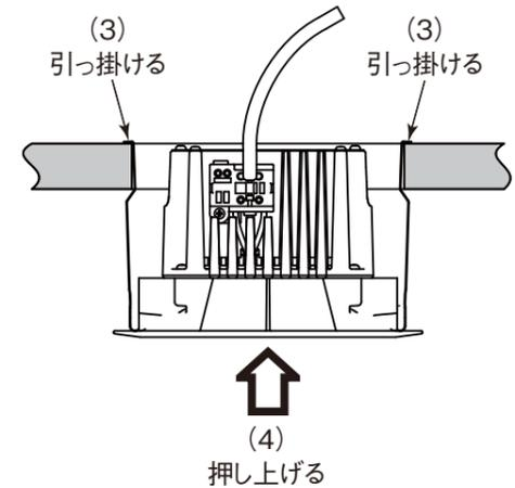
※天井板厚5mmの場合、天井との間に隙間が空くことがあるので、この場合は一度取付バネを押し広げてから挿入する。
