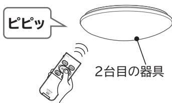
●チャンネル設定を変えたい器具以外も反応して、同時に設定されてしまう場合は、電源(壁スイッチまたはブレーカ)を切り、対象器具以外のコネクタを外してからチャンネル設定をしてください。
