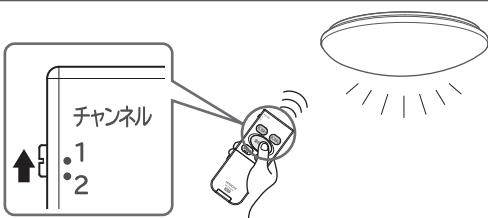
※出荷時は、チャンネル「1」に設定しています。リモコンのチャンネル切替スイッチ位置が「1」になっていることを確認のうえ、器具にリモコンを向けて操作してください。
