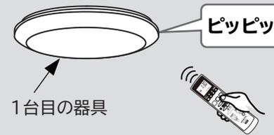
**4** リモコンのチャンネル切替ボタンを押して、表示画面のチャンネル表示を“チャンネル2”にしてください。
