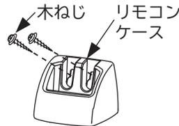
※リモコンケースにリモコンを入れて器具の近くに置く時のために、リモコンケースを上によらずして取り外せるように取り付けると便利です。
