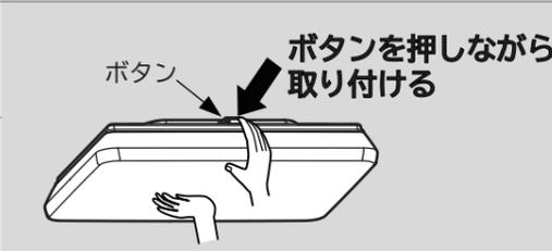
●天井に付いている配線部品により、本体に掛かる爪の位置が変わるので、下の図を参照し、適切な爪(両側2か所)が本体に掛かっていることを確認する。
