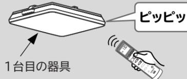
4 リモコンのチャンネル切替ボタンを押して、表示画面のチャンネル表示を"CH2"にしてください。
