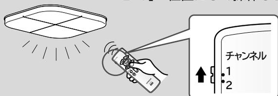
リモコンのチャンネル切替スイッチを「2」の位置にして操作します。
