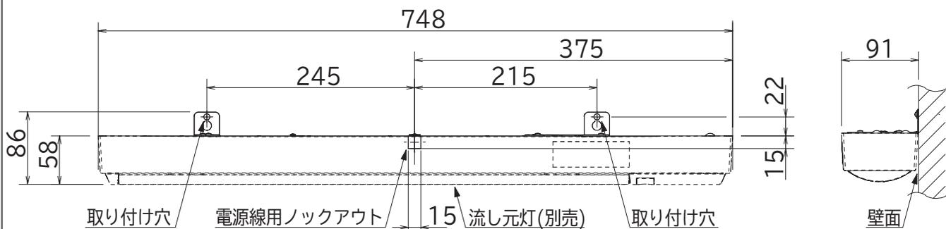
施工壁面の正面から見た取付け穴・電源線用ノックアウト位置
