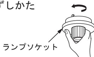
3. ランプをランプソケットに取り付け、点灯確認してください。
