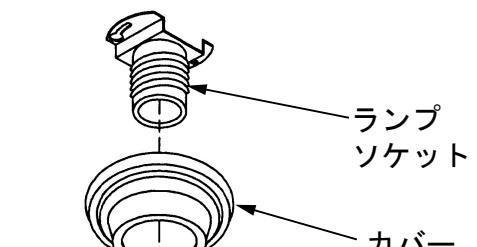
(4) ランプをランプソケットに取り付け、点灯確認してください。
