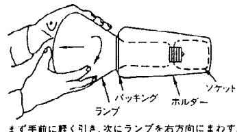
①ランプをホルダー内のソケットに差込み、右方向にまわして下さい。
