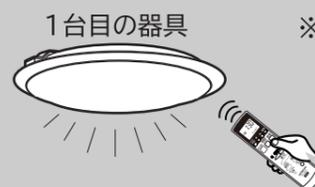
※チャンネル切替ボタンを押して、チャンネル表示を「チャンネル1」にして操作します。
