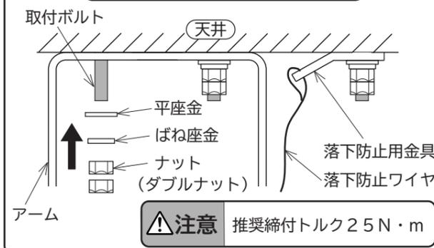
傾斜天井への取付 (図3)
