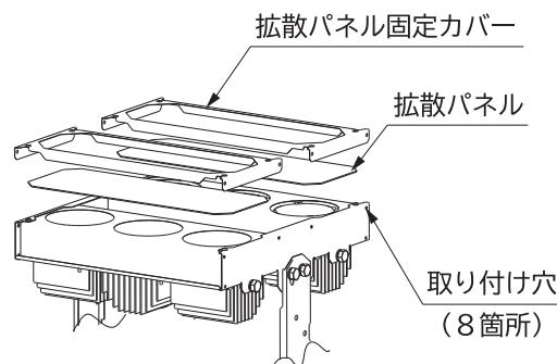
※拡散パネルは表面が平坦な面(ツルツル面)を本体側シボ面(ザラザラ面)を外向きにして取り付けてください。
