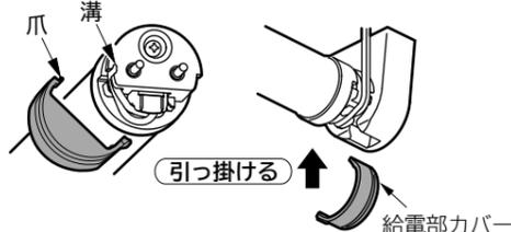
5. 給電部カバーを確実に取り付ける。
