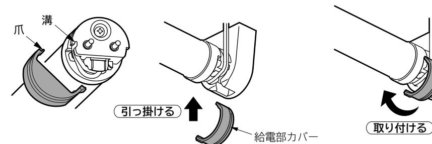
5. 給電部カバーを確実に取り付ける。
