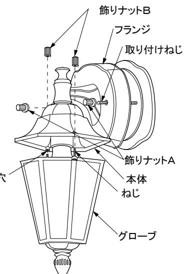
4. ランプをソケットにねじ込んだのち、点灯確認をしてください。
