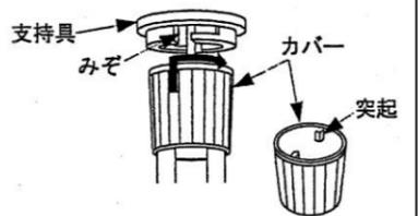
(3) 引掛シーリングキャップを天井の配線部品に差し込み右へいっぱいひねって取り付けてください。
