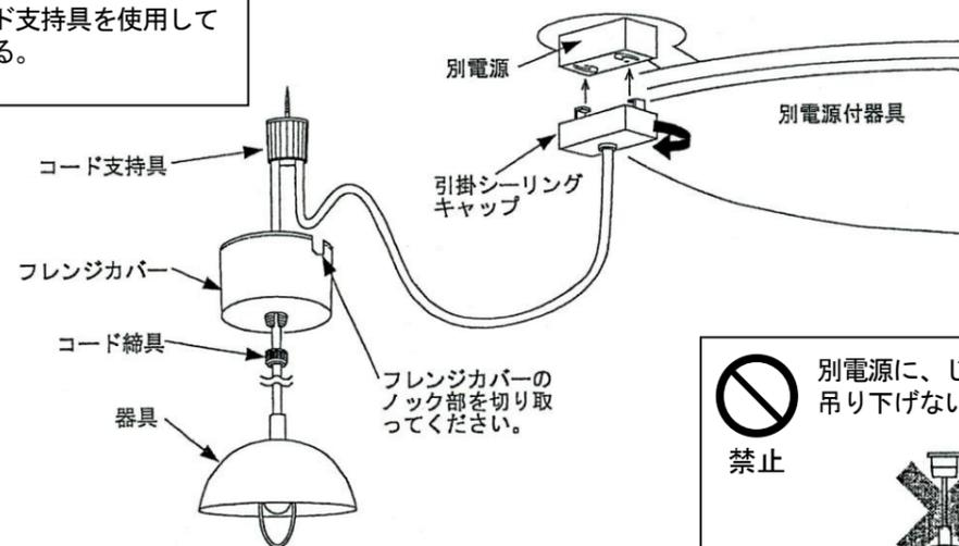
！別電源付器具に取付ける場合は別電源付器具の定格(電流、ワット数)に注意する。
