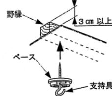
！野縁などの補強材のある所に取り付ける。
