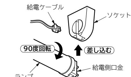
1. 給電ケーブルと給電側口金の位置を合わせ、ランプをソケットに差し込み90度回転させる。
