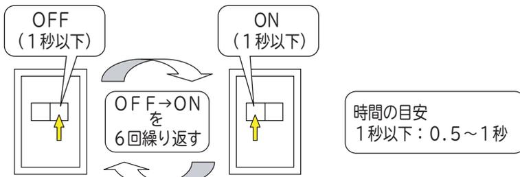
解除操作後、明るさが変化しない場合は、照度補正機能の解除が正しく行われていません。再度、解除操作を行ってください。
