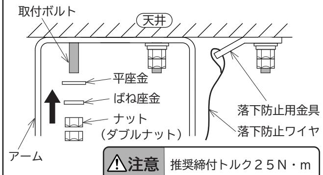
傾斜天井への取付 (図3)
