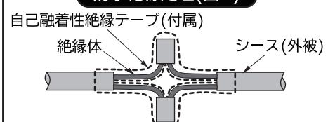
隙間が生じない様に絶縁体の間も自己融着性絶縁テープを巻き防水絶縁処理をしてください。
