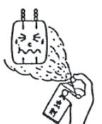
■金属棒等で電撃格子に絶対にさわらないでください。また、器具のすきま・穴に金属物等を差し込まないでください。感電・火災・故障の原因となります。
