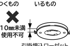
このような場合は、配線器具を交換してください。配線器具の交換や配線器具が天井に付いていない場合は、電気工事店(有資格者)に工事を依頼してください。
