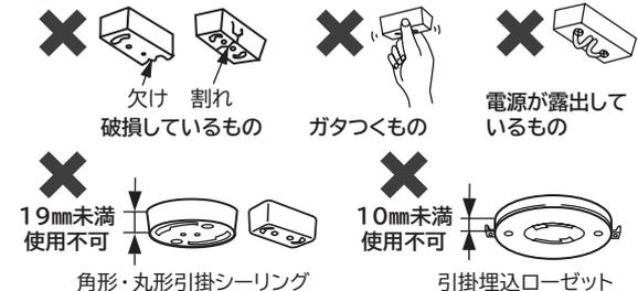
このような場合は、配線器具を交換してください。配線器具の交換や配線器具が天井に付いていない場合は、電気工事店（有資格者）に工事を依頼してください。
