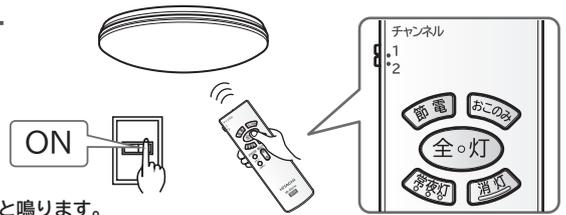
**壁スイッチで操作する** 点灯するとき壁スイッチをONにする／消灯するとき壁スイッチをOFFにする
