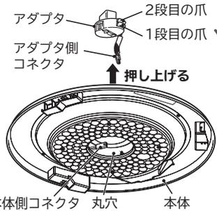
●本体に掛かる爪の位置が配線器具で変わります。下図を参照し、適切な爪(両側2か所)が本体に掛かっていることを確認する
