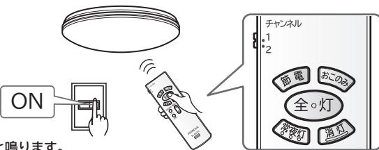
**壁スイッチで操作する** 点灯するとき壁スイッチをONにする／消灯するとき壁スイッチをOFFにする
