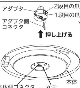
●本体に掛かる爪の位置が配線器具で変わります。下図を参照し、適切な爪(両側2か所)が本体に掛かっていることを確認する
