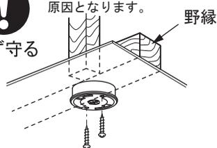
付属の丸形引掛シーリングボディへの電線接続方法
