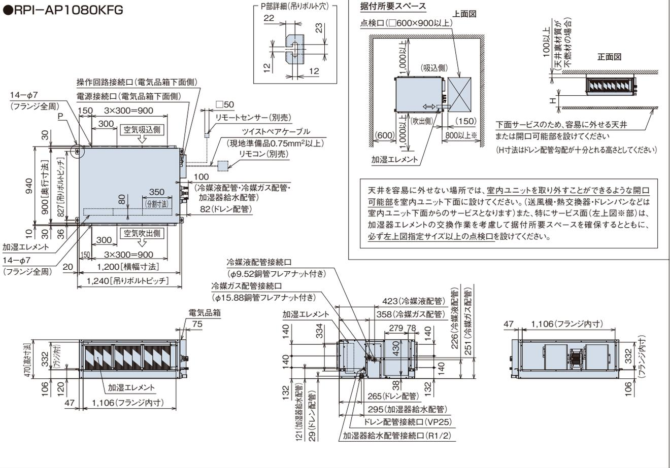
天井を容易に外せない場所では、室内ユニットを取り外すことができるような開口可能部を室内ユニット下面に設けてください。(送風機・熱交換器・ドレンパンなどは室内ユニット下面からのサービスとなります)また、特にサービス面(左上図※部)は、加湿器エレメントの交換作業を考慮して据付所要スペースを確保するとともに、必ず左上図指定サイズ以上の点検口を設けてください。
